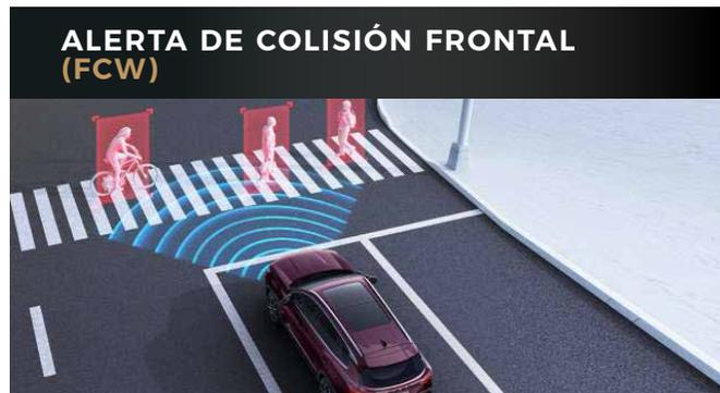
Permite mediante sensores ubicados en la parte frontal, monitorear las condiciones de tráfico, en caso de detectar obstáculos inesperados en frente, el TIGGO 8 PRO realiza un frenado de emergencia. De esta manera advirtiendo la presencia de algún objeto y así permitiendo un frenado oportuno.
