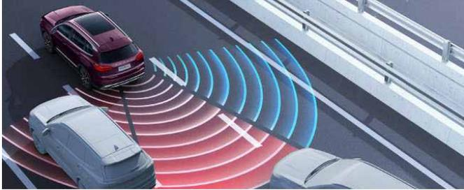
El poder rebasar o cambiarse de carril puede ser una maniobra peligrosa en carretera, en especial si no se tiene un panorama claro del otro carril (el punto ciego). En el TIGGO 8 PRO el BSD permite que, mediante radares microondas, se alerte al conductor si es factible el cambio de carril o no.
