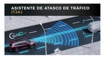
El Asistente de Atasco de Tráfico monitorea los movimientos de los vehículos en carriles cercanos, avisando al conductor y mostrando en pantalla una alerta cuando éste note que el carril por donde va con menor movimiento. Permitiendo así una sugerencia de cambio de carril para avanzar más rápido.
