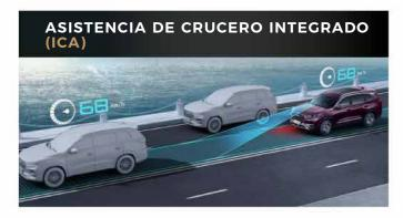
La Asistencia de Crucero Integrado permite monitorear las condiciones de tráfico, copiando la trayectoria del vehículo que se encuentra adelante. De esta manera controla la dirección del volante de forma automática con la trayectoria correcta para reaccionar en caso de emergencia.
