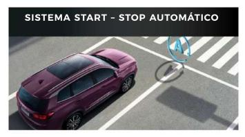
El vehículo al permanecer estático (ej.: semáforo en rojo) apagará el motor hasta que este se vuelva a encender mediante el conductor presionando el acelerador.
