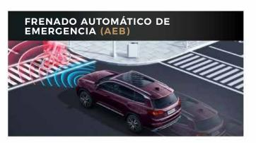
Permite mediante sensores ubicados en la parte frontal, monitorear las condiciones de tráfico, en caso de detectar obstáculos inesperados en frente, el TIGGO 8 PRO realiza un frenado de emergencia.
