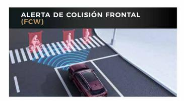
Permite mediante sensores ubicados en la parte frontal, monitorear las condiciones de tráfico, en caso de detectar obstáculos inesperados en frente, emite una alerta sonora y visual en el tablero, previniendo posible colisión.
