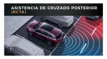
El Asistente de Tráfico Cruzado Posterior monitorea condiciones de tráfico en un rango de 30m, detectando si existen obstáculos o vehículos que no son visibles por los espejos retrovisores.
