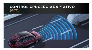
El Control Crucero Adaptativo permite monitorear las condiciones del tráfico, copiando la velocidad del vehículo que se encuentra adelante. El TIGGO 8 PRO regula los cambios de velocidad de manera autónoma y así manteniendo una distancia segura para reaccionar en casos de emergencia.
