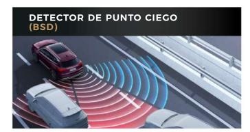
El poder rebasar o cambiarse de carril puede ser una maniobra peligrosa en carretera, en especial si no se tiene un panorama claro del otro carril (el punto ciego). En el TIGGO 8 PRO el BSD permite que, mediante radares microondas, se alerte al conductor si es factible el cambio de carril o no.
